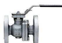
Flansch-Kugelhahn ANSI 150 aus Edelstahl AISI316-CF8M un C-Stahl WCB, mit vollem Durchgang, mit Aufbauplatte nach ISO 5211, Baulänge nach ANSI B 16.10, Fire Safe und antistatische Ausführung.
