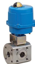
3-Wege Flansch-Kugelhahn PN16, aus Edelstahl AISI 316, vierseitig abgedichtet, "L" und "T" Bohrung, voller Durchgang, antistatische Ausführung, mit elektrischem Drehantrieb Serie 86.
