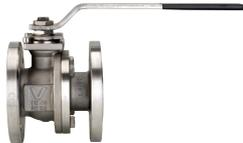
Flansch-Kugelhahn PN16 aus Edelstahl AISI 316-CF8M, voller Durchgang, Baulänge nach DIN 3202 F4/F5, Fire Safe und antistatische Ausführung.
