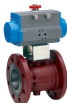
2-Wege Flansch-Kugelhahn, PN16, aus Grauguß G250, mit Kugel und Spindel aus Edelstahl AISI 304 (Baulänge nach EN558 basic Series 14 - DN 200 basic Series 27), mit pneumatischem Drehantrieb.
