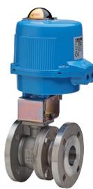
Flansch-Kugelhahn PN40, aus Edelstahl AISI 316 CF8M, voller Durchgang, Fire Safe, Antistatik, Baulänge nach EN558 Basisserie 27, klassifiziert ATEX Ex II 2 G / D c T3, mit elektrischem Antrieb der Serie 86.
