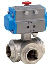
3-Wege Kugelhahn aus Messing CW 617N, mit PTFE+FKM Dichtungen, Gewinde F/F/F, voller Durchgang, "T" oder "L" Bohrung, mit pneumatischem Drehantrieb.
