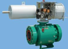
🇩🇪 Geteilter Kugelhahn mit Zapfen-gelagerter Kugel, nach API6D/API6A. 2/3-teiliges geschmiedetes Gehäuse. ANSI 150#-2500# und API 2000 - 10000 PSI. Nennweiten bis 48" verfügbar. Aus Stahl, Edelstahl oder Nickel-Legierung.
