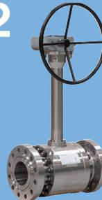
🇩🇪 Geteilter Kugelhahn mit Zapfen-gelagerter Kugel, nach API6D/BS6364. Mit Schaltwellenverlängerung für Kryotechnik bis -196°C. Druckstufen ANSI 150#-2500#. Bis 24", Aus Edelstahl oder Nickel Legierung.
