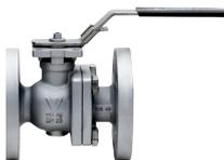
Flansch-Kugelhahn PN16 aus Edelstahl AISI316-CF8M un C-Stahl WCB, voller Durchgang, mit Aufbauplatte nach ISO 5211, Baulänge nach EN 558 basic Series 27, Fire safe und antistatische Ausführung.
