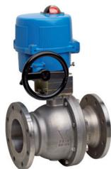
Split-Body Flansch-Kugelhahn PN16 aus Edelstahl AISI 316-CF8M, voller Durchgang, Baulänge nach EN 558 Basic Series 27, Fire Safe und antistatische Ausführung, mit elektrischem Drehantrieb Serie 86.
