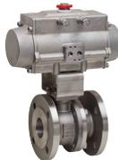
Flansch-Kugelhahn PN16 aus Edelstahl AISI 316-CF8M voller Durchgang, Baulänge nach EN 558 basic Series 27, Fire Safe und antistatische Ausführung, mit pneumatischem edelstahl Drehantrieb.
