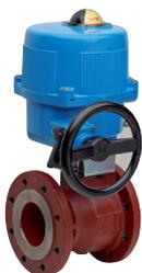
Flansch-Kugelhahn aus Grauguß, PN16, voller Durchgang, Baulängen DN25 bis DN200 nach EN 558 Basic Serie 14 (DN 200 basic Serie 27), mit elektrischem Drehantrieb Serie 86.
