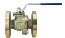
Flansch-Kugelhahn PN40 aus C-Stahl LCB voller Durchgang, Baulänge nach EN 558 basic Series 27, Fire Safe und antistatische Ausführung.
