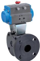
3-Wege Kompakt-Flansch-Kugelhahn Wafer Typ, aus C-Stahl ASTM A105, PN16 Zwei Sitzringe (Verteiler), reduzierter Durchgang, "T" oder "L" Bohrung, mit pneumatischem Drehantrieb.
