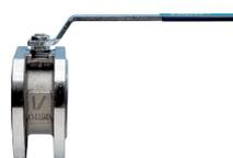
🇩🇪 Flansch-Kugelhahn PN16/40 aus Edelstahl A351-CF8M, voller Durchgang, V-Pack Spindeldichtung, Baulänge EN 558 Serie 100, Fire Safe und Antistatik.
