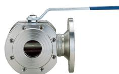
🇩🇪 3-Wege Flansch-Kugelhahn PN16, Verteiler, aus Ede stahl AISI 316, "L" Bohrung, mit 2 Dichtungen und mit reduziertem Durchgang.
