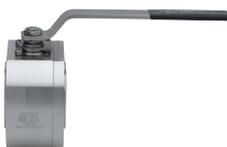
Kompaktflansch-Kugelhahn Split-Wafer Ausführung PN100, mit vollem Durchgang, antistatische Ausführung, Baulängen ab UNI EN 558 basic Series 101, Fire Safe.
