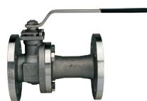
Flansch-Kugelhahn PN16 aus Edelstahl AISI 316-CF8M, voller Durchgang, Baulänge nach DIN 3202 F1, Fire Safe und antistatische Ausführung.
