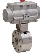
Kompaktflansch-Kugelhahn ANSI 300 metrisch, mit vollem Durchgang, mit pneumatischem edelstahl Drehantrieb.
