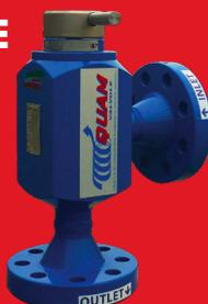
■ Drosselventile "Rotating Disk": einstellbare Öffnung. Das Trim besteht aus zwei Scheiben (eine feste und eine rotierende), die für Anwendungen mit niedrigem/mittlerem Differenzdruck empfohlen werden.
