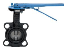
🇩🇪 Wafer Absperrklappe PN16, Gehäuse aus Grauguss G250 mit Epoxy Beschichtung, EPDM Dichtung.
