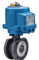
2-Wege Kompakt-Kugelhahn PN16 mit Flansch, aus C-Stahl LCB, voller Durchgang, Antistatik und ISO 5211-Direktaufbauflansch, mit elektrischem Antrieb Serie 86.
