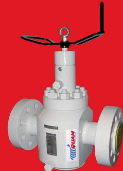
■ Absperrschieber "Double Expanding Through Conduit" erweiterbarer Verschluss und parallele Flächen, lineare Wirkung, empfohlen für viskose und verschmutzte Anwendungen.
