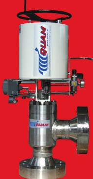
■ Drosselventile "External Sleeve and Cage": Einstellbare Öffnung, externer zylindrischer Stopfen und zylindrischer Käfig mit radialen Löchern: die Steuerung erfolgt durch die Bewegung des Verschlusses aus dem Käfig. Für Anwendungen mit hohem Differenzdruck, kritischen Anwendungen und Erosionsbeständigkeit empfohlen.
