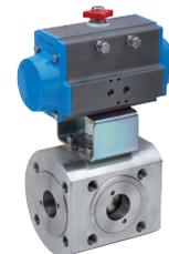
3-Wege Kugelhahn Typ Combi-Sfer, "L" oder "T" Kugelbohrung, allseitige Kugeldichtung, PN16 Flanschanschluß, C-Stahl ASTM A105, voller Durchgang, mit Drehantrieb.
