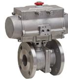
Flansch-Kugelhahn PN16 aus Edelstahl AISI316-CF8M, voller Durchgang, mit Aufbauplatte nach ISO 5211, Baulänge nach EN 558 basic series 27, Fire Safe und antistatische Ausführung, mit pneumatischem edelstahl Drehantrieb.
