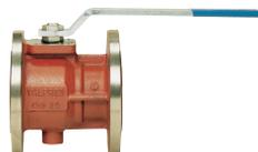
Flansch-Kugelhahn aus Grauguss mit vollem Durchgang, Baulängen ab EN 558 basic Serie 14 (DN 200 basic Serie 27).
