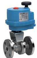
Flansch-Kugelhahn ANSI300, aus Edelstahl AISI 316-CF8M, voller Durchgang, Baulänge nach ANSI B16.10, Fire Safe und antistatische Ausführung, mit elektrischem Drehantrieb Serie 85.
