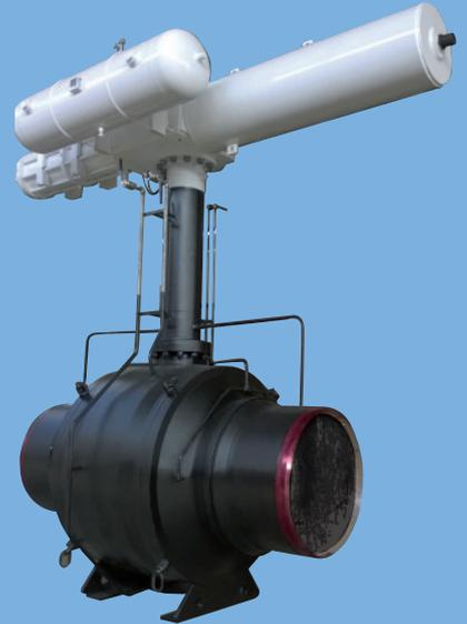
🇩🇪 Kugelhahn mit zapfengelagerter Kugel, nach API6D. 2 bzw. 3 - teiliges rundum verschweißtes Gehäuse aus Schmiedestahl. Druckstufen ANSI 150#-2500#. Nennweiten bis 48" verfügbar.
