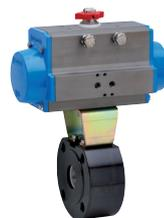
2-Wege Wafer Flansch-Kugelhahn aus C-Stahl ASTM A105, mit Kugel und Spindel aus Edelstahl AISI 304, mit pneumatischem Drehantrieb.
