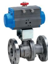
Flansch-Kugelhahn ANSI 300, Stahlguß WCB, voller Durchgang, Baulänge ANSI B16.10, Fire Safe und Anti-Statik komplett montiert mit pneumatischem Drehantrieb.
