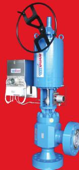
■ Drosselventile "Internal Plug & Cage": einstellbare Öffnung, interner zylindrischer Verschluss und zylindrischer Käfig mit radialen Löchern: die Steuerung erfolgt durch die Bewegung des Verschlusses im Käfig. Ein- oder mehrstufige Trimmung, empfohlen für Anwendungen mit hohem Differenzdruck und Kavitations-/Geräuschschutz.
